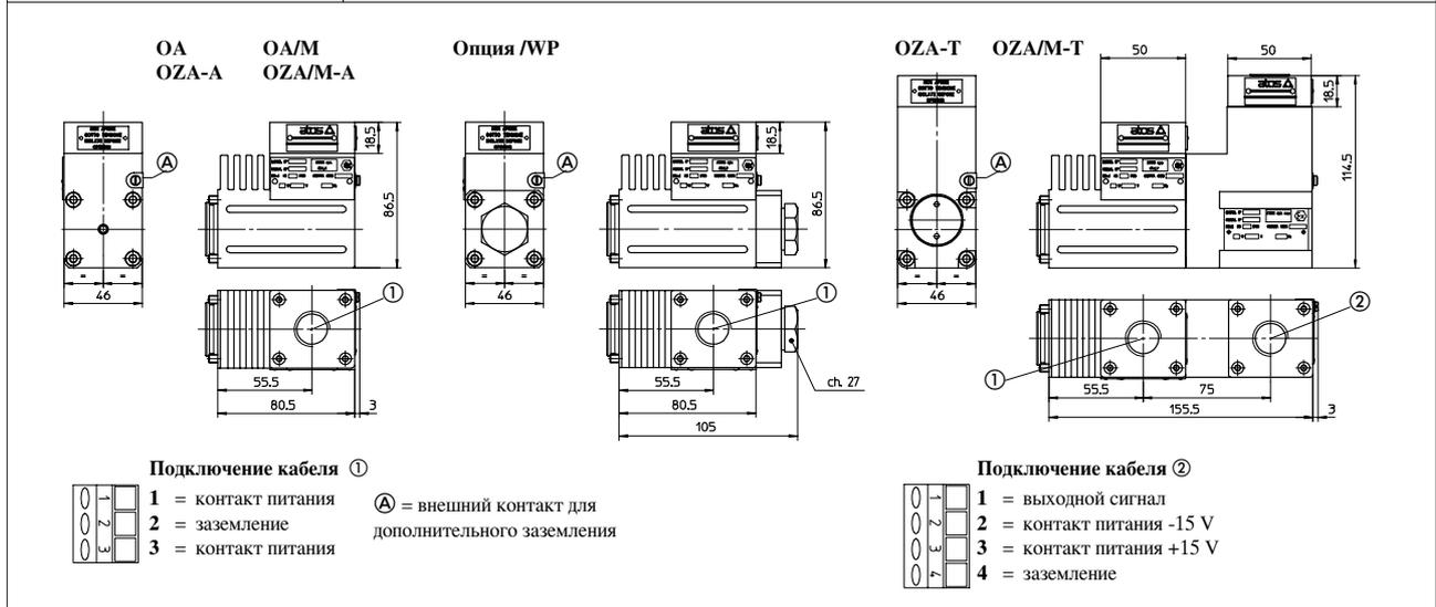
(1) В случае исполнения для переменного тока, диодный мост встраивается внутрь электромагнита
